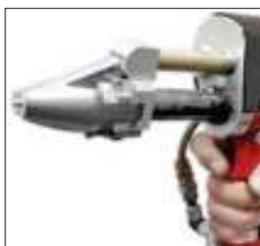
Fase 2 - Carico rivetto Phase 2 - Blind rivet load
