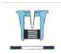
Preparare un foro del diametro corretto. Make a hole of the recommended size.
