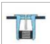
Spingere l'inserto dentro al foro. Press the fastener into the hole.
