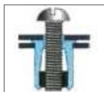
Avvitare la vite fino a che non si incontra resistenza o fino ai limiti di torsione indicati. Drive the screw until solid resistance is felt, or up to recommended torque limits.
