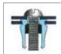
Avvitare finché il componente non è fisso. Screw until the component does not turn.
