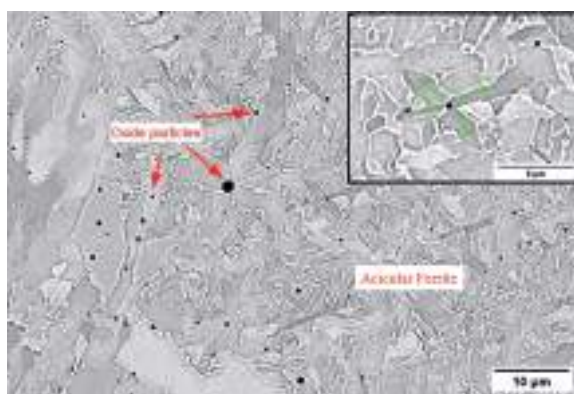
Fig.4 Micrografia SEM della microstruttura del giunto, composta essenzialmente da ferrite aciculare. L'inserto mostra la germinazione delle lamelle di ferrite a partire da ossidi. Fig. 4 SEM micrograph showing acicular ferrite as the main microstructure of the weld. Higher magnification shows the nucleation of acicular ferrite laths at micro-scale oxide particles.
