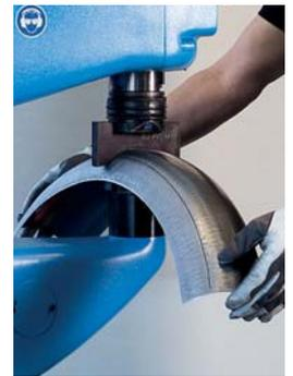
ECKOLD Werkzeuge eignen sich zum Stauchen, Strecken, Wölben, Glätten, Spannen, Richten, Bördeln, Schweißen, Ausschneiden, Lochstanzen und Abkanten von Blechen. Für alle Umformarbeiten und Werkstoffe das richtige Werkzeug.
