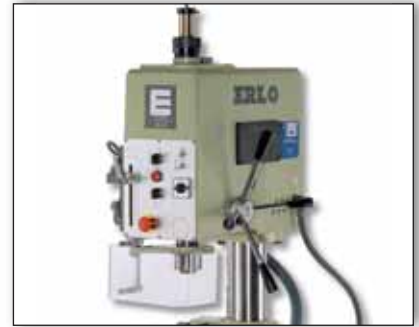
Roscado por husillo patrón (ver serie SH) Tapping system by lead screw (look serie SH) Filetage par vis mere (voir série SH) Leistspindel gewindeschneidesystem (serien SH)
