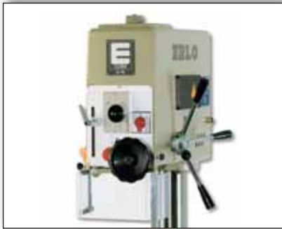
Volante frontal para avance sensitivo fino Frontal wheel for fine sensitive feed Volant frontal pour avance sensitif fine Vorderes handrad für den vorschub bei feinfarbeitongen und plandrehen
