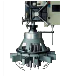
Cabezal múltiple de husillos ajustables. Multispindle headstock with adjustable spindles. Tête multibroche avec broches réglables. Mehrfachkopf mit einstellbaren Spindeln.
