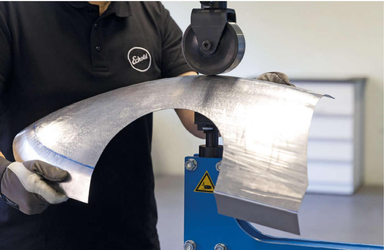
Unsere Multiformer sind ideale Geräte zum Rollstrecken, Glätten und Stauchen. Die robuste Konstruktion erlaubt schnelles Arbeiten und perfekte Resultate. Durch die Kombination von verschiedenen Umformarbeiten in einem Gerät sparen Sie Platz und erhöhen die Effizienz. Die smarte Bauweise erlaubt jederzeit ein Upgrade der Geräte. Multiformer: Modular, effizient und hochwertig.
