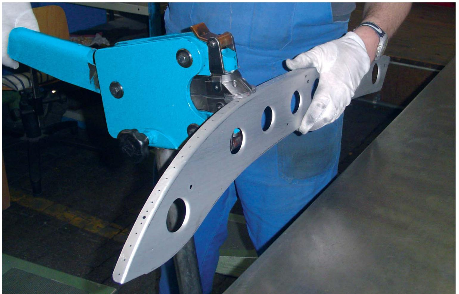
Stauhen und Strecken sind unverzichtbare Anwendungen im Flugzeugbau, denn damit werden viele Arten von gepressten Teilen korrigiert oder angepasst. Die speziellen Maschinen und Werkzeuge von ECKOLD bieten eine hoch effiziente Lösung zur präzisen Anpassung von individuellen Teilen.
